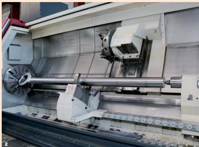
**1** In der Heynumat 21 setzt Turbomech auch angetriebene Werkzeuge ein. **2** Bearbeitung von Bauteilen bis vier Meter Länge in der größeren Heynumat 24.
