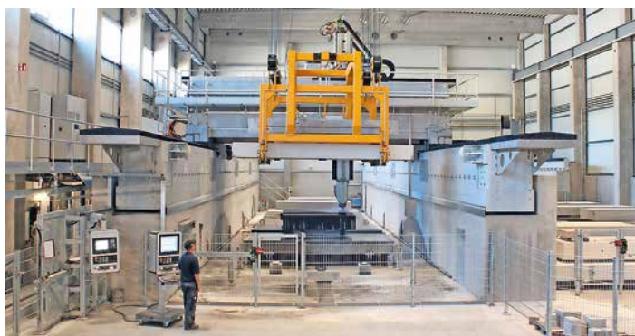
Großbearbeitungszentrum bei Reitz Natursteintechnik. Auf der Gantry-Maschine können Granitblöcke bis zu Abmessungen von 12.000 mm x 4.300 mm x 1.500 mm \mu -genau bearbeitet werden.
