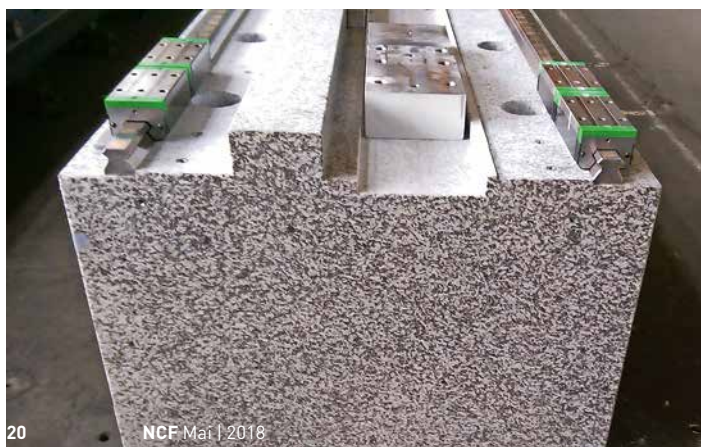
Fertig bearbeitetes Granit-Maschinenbett mit montierten Führungsbahnen für eine Heynuform-Gantry-Anlage. Die Maschine verfügt über zwei Betten dieser Bauart.
