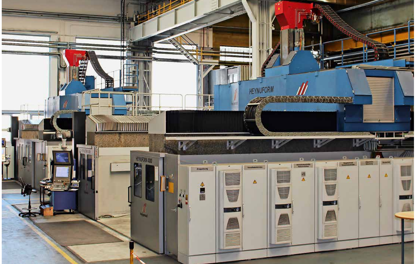
Imposanter Anblick: Die beiden Anlagen haben jeweils rechts und links zwei monolithische Granitblöcke, von denen jeder 12 m lang und 20 t schwer ist.
