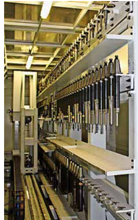
Im Werkzeugmagazin befinden sich fast 200 Werkzeuge mit SK-50- und HSK-Schnittstelle.
