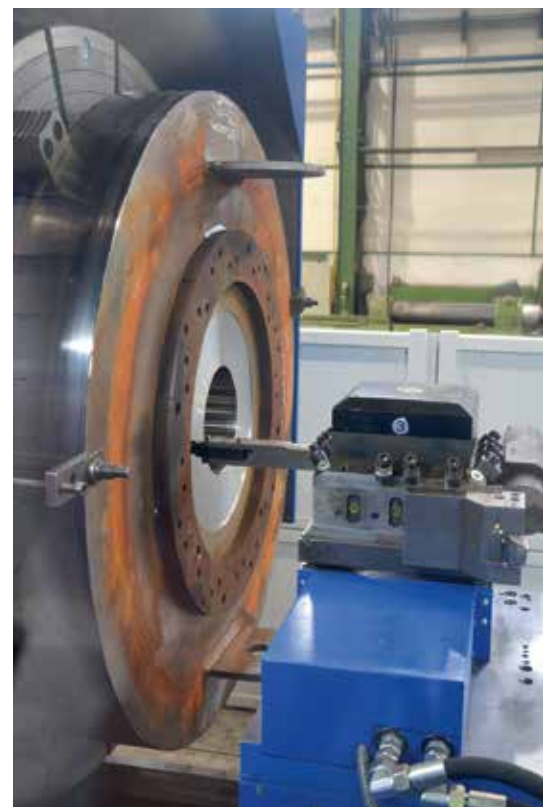
3 Auch kurze Teile können gedreht, gebohrt und gefräst werden: hier die Bearbeitung eines großen Aggregatedeckels auf der modernisierten Schwerdrehmaschine von Heyligenstaedt (© Hanser)
