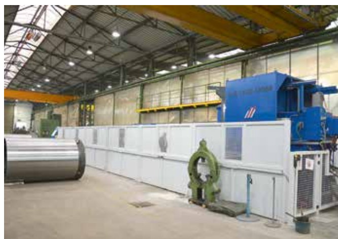
2 Vorher-nachher: links der Status der Maschine an ihrer alten Wirkungsstätte, rechts die neuwertige Gebrauchtmachine nach ihrer Modernisierung, installiert bei Buss-SMS-Canzler in Butzbach; das Alter von 30 Jahren ist nicht zu erkennen (© links: Heyligenstaedt, rechts: Hanser)
